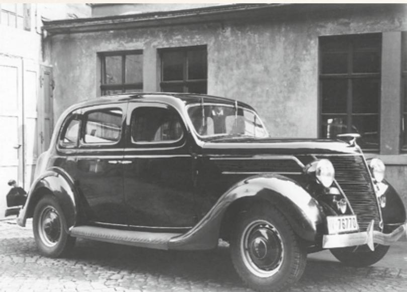
**Abb. 46** RUCKS Firmenwagen, Ford V 8, 8 Zylinder V Motor mit 3620 ccm Hubraum, Karosserie von Ambi-Budd (Berlin), Leistung: 90 PS, ca. 1937
