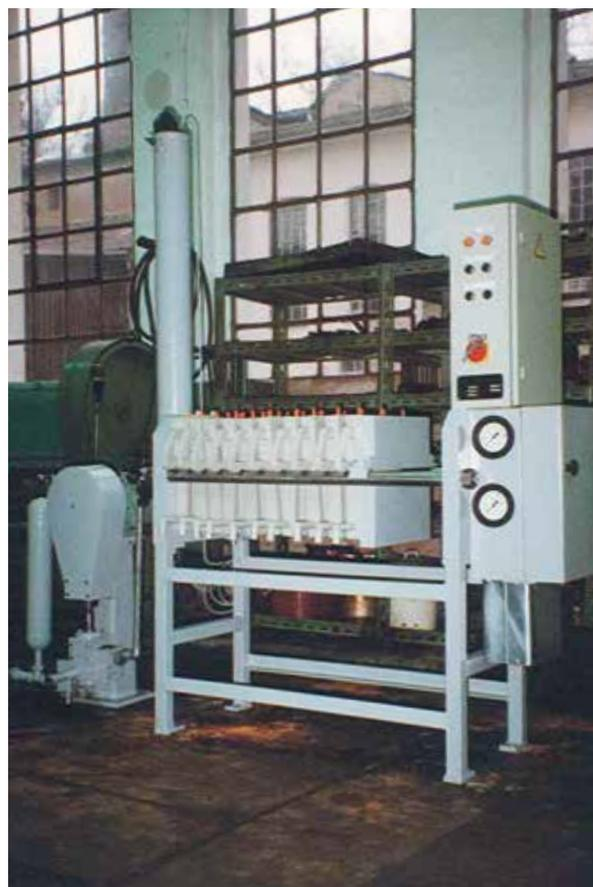
**Abb. 73** Prototyp Kammerfilterpresse, KV 075, 1991
